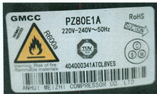
Photo de la plaque signalétique du compresseur et de l'appareil
